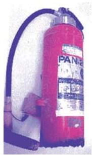
破裂した消火器
