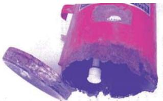
破裂した消火器(底部分)
